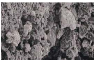
Magnification 200X нетретиран бетон
